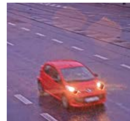
Obraz 3. Przykład obrazu zestawionego z dwóch naświetlań przy działającej funkcji WDR w kamerze przy niskim poziomie oświetlenia sceny
