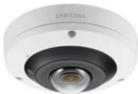
PNF-9010RVM to wandaloodporna kamera hemisferyczna 4K
