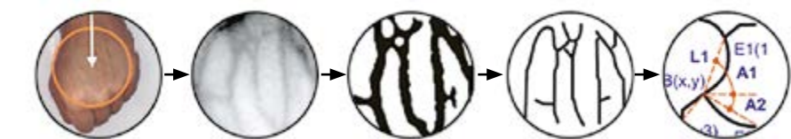
Rys. 4. Analiza obrazu żył napięstka w ramach technik biometrycznych w systemach KD
