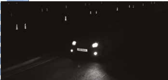
Rys. 6. Przykład zdjęcia uzyskanego z kamery ANPR wyposażonej w wąskopasmowy filtr bliskiej podczerwieni
