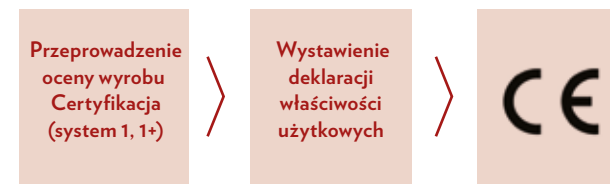
Rys. 1. Skrócony schemat drogi do „oznakowania CE”
