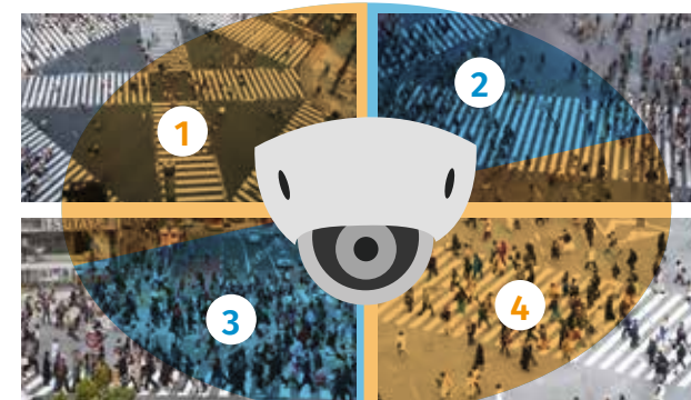
Rys. 1. Przykład kamery wieloprzetwornikowej wielokierunkowej
