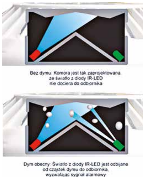
Rys. 1. Zasada działania czujek optycznych dymu
